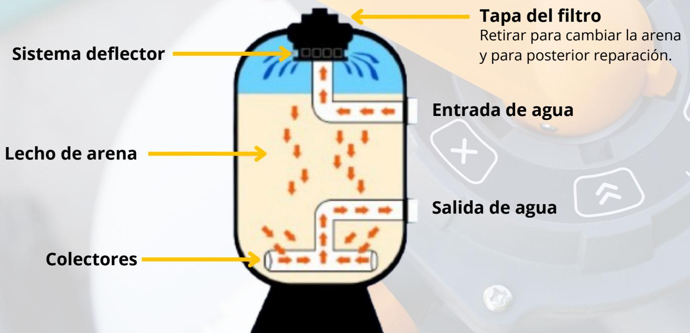
El agua de la piscina entra en el filtro superior y va descendiendo por el medio filtrante que puede ser arena, zeolita mineral o el cristal verde, quedando libre de impurezas, después pasa por los colectores para volver a la piscina ya limpia.
