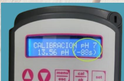
La calibración consta de dos parte la primera calibra patrón pH 7, dura como se ve en la imagen 90 segundos. Pasado este tiempo, nos pedirá lavar la sonda en agua y pasar al patrón pH 9. Una vez terminado el proceso nos debería salir el mensaje de "Calibración 100%", pondremos la sonda en su sitio.
